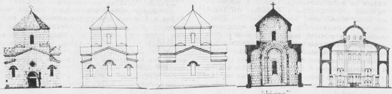
41. Арамус. Западный, восточный, северный фасады и разрез по оси север-юг (рек. Т. А. Марутяна).
